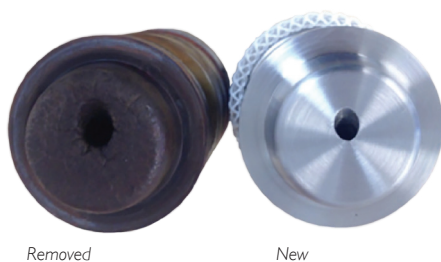
Figura 2 – Portas de cámaras de pre-combustión viejas y nuevas Removido
